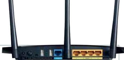
Установленный на плате гигабитный контроллер имеет пять выходов. Один из них предназначен для работы с внешней сетью, а четыре остальных — для работы с локальной. Двухдиапазонный радиомодуль поддерживает передачу данных на скорости до 300 Мбит/с на частоте 2,4 ГГц и 450 Мбит/с на частоте 5 ГГц. К тому же он делает это одновременно на двух частотах.
