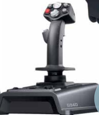
признаки пилотажного инструмента — бесконтактные датчики Холла, контролирующие положение РУС (они точнее и надежнее обычных резистивных датчиков), возможность вращать РУС вокруг своей оси и т.д.
