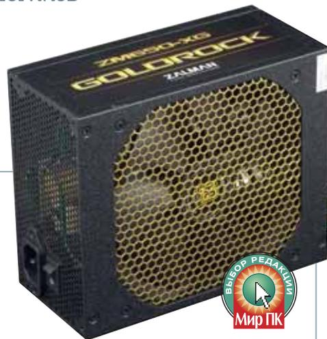
Заявленные 650 Вт блок выдал, но с трудом — при загрузке канала +12 В на 300 Вт напряжение упало до 11,78 В, а на 450 Вт оно составило 11,56 В. Напряжение на канале 3,3 В при загрузке на полную мощность опускалось до 3,18 В, что вполне приемлемо.
